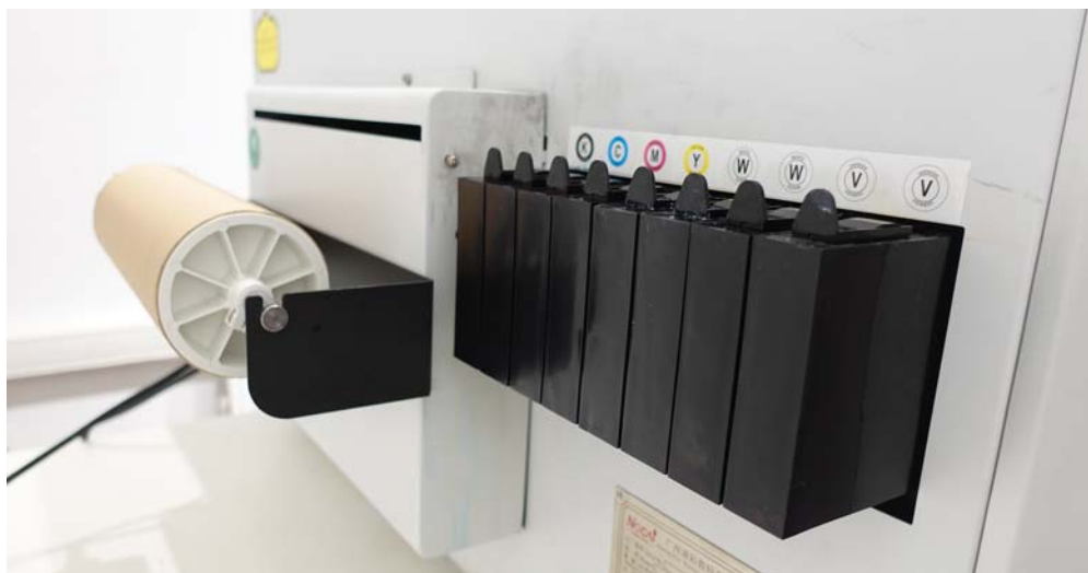
Опциональные приспособления превращают планшетный УФ-принтер в рулонный
